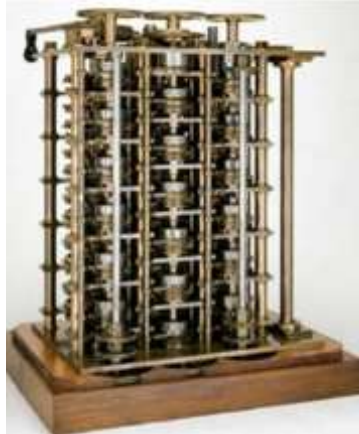
Figura 5 Máquina Diferencial de Babbage
